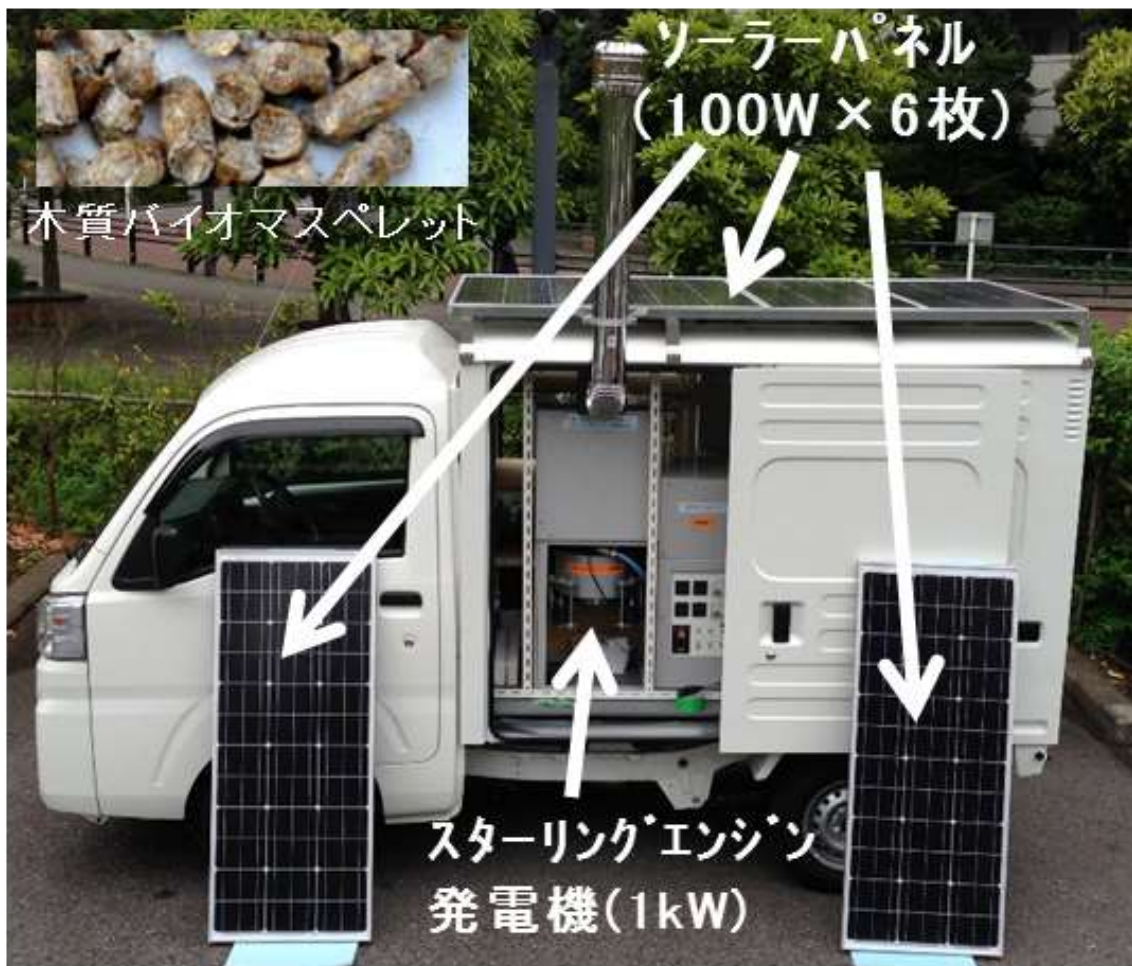
(資料 1) 木質バイオマス燃料スターリングエンジンとソーラー発電のハイブリッド電源車
